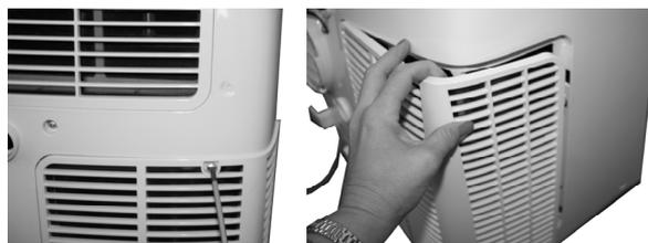
Usare un aspirapolvere per asportare la polvere dai filtri. Se ciò non fosse sufficiente, lavare il filtro con acqua tiepida ed eventualmente detergente neutro, sciacquarlo con acqua fredda e lasciarlo asciugare naturalmente prima di rimetterlo al loro posto. Una volta reinserito il filtro, richiudere la griglia e riprendere l'utilizzo del climatizzatore.
