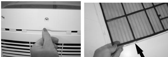
**Per rimuovere il filtro 2**, svitare le due viti che trattengono il filtro con il cacciavite e tirare la copertura del filtro verso destra.
