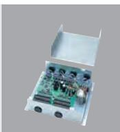
Comando a filo completo che consente il controllo completo delle unità ed offre funzionalità di autodiagnostica e programmazione centralizzata, automatica o manuale
