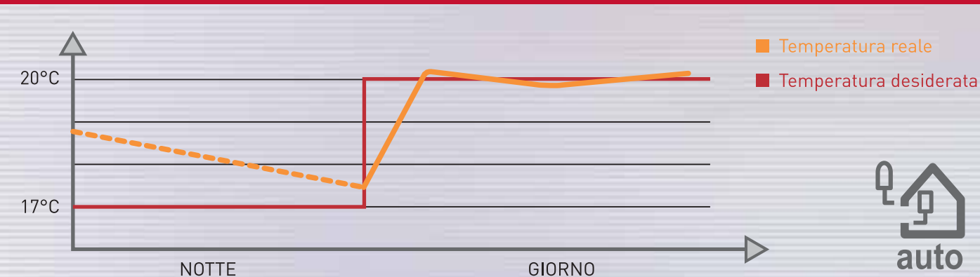
Funzionamento della caldaia GENUS con funzione AUTO inserita
