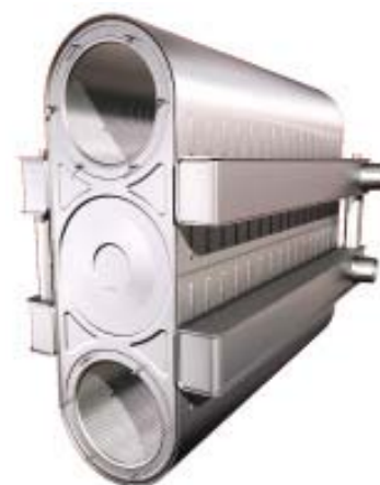
Scambiatore di calore primario spiroidale in acciaio INOX, con ulteriori spire "secondarie" dedicate all'esclusivo recupero di calore latente.
