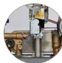
Gruppo idraulico in ottone. Con valvola a 3 vie elettrica e flussometro a turbina che modula la potenza in base alla portata d'acqua sanitaria.
