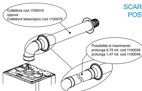
Scarico concentrico posteriore/laterale
