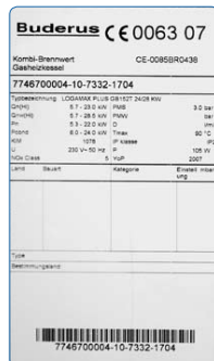
Esempio targhetta caldaia murale
