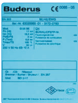
Esempio targhetta caldaia a basemento
