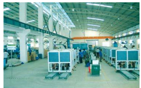
Produzione air chiller
