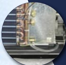
**BATTERIA DI SCAMBIO** in tubi di rame, con alettatura turbolenziata in alluminio ad alta efficienza, prevista per il funzionamento ad acqua calda o fredda. Ha una grande capacità di raffreddamento e deumidificazione ed è collegata con tubi flessibili a doppio strato (interno EPDM, esterno acciaio INOX) che riportano gli attacchi di mandata e ritorno nella parte bassa dell'apparecchio per facilitare le operazioni di installazione.
