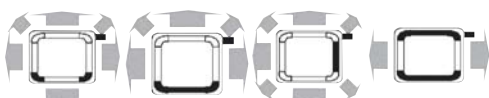
mandata a 4 vie mandata a 3 vie mandata a 3 vie mandata a 2 vie
