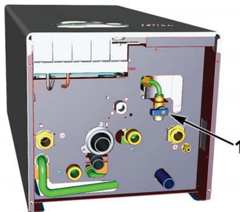
fig. 7 - Robinet de remplissage
