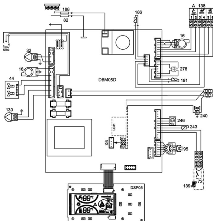
**Attenzione:** Prima di collegare il termostato ambiente o il cronocomando remoto, togliere il ponticello sulla morsettera.
