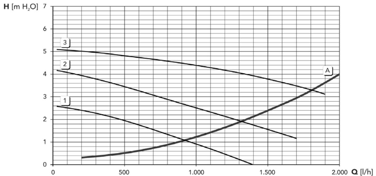
**A** Perdite di carico caldaia
