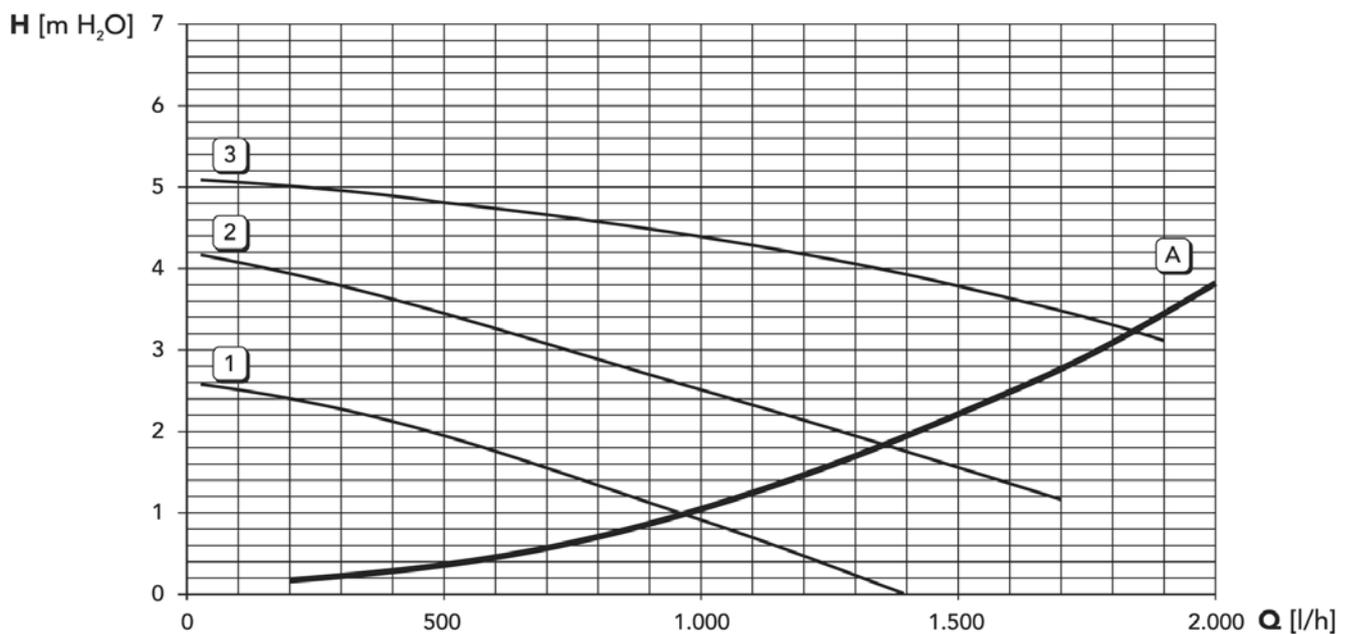
**A** Perdite di carico caldaia
