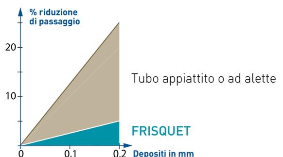
INCROSTAZIONE CORPO CALDAIA,
