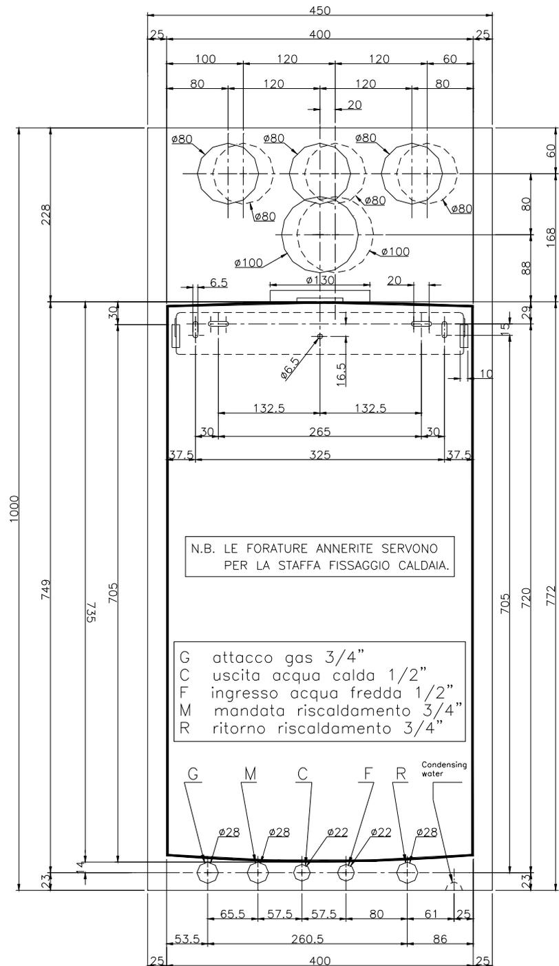
**C-F: Non per SOLAR SYSTEM** (nella versione SYSTEM sono esclusi tutti i componenti contrassegnati con (\*) in quanto si tratta di una caldaia con circuito per solo riscaldamento)
