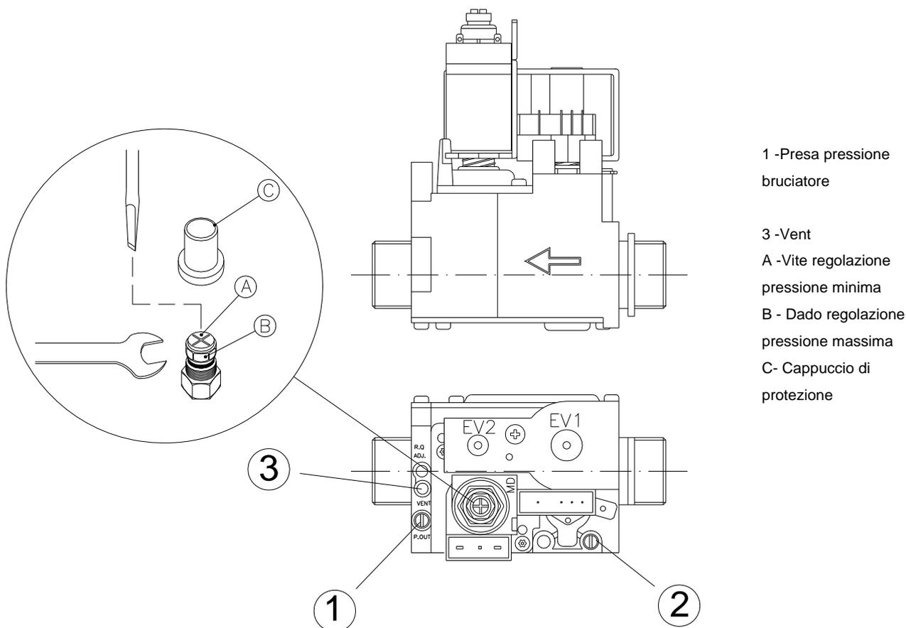
Per eseguire il controllo delle pressioni al bruciatore, inserire le sonde del manometro nelle prese di pressione disponibili sulla valvola gas (vedi fig.).
