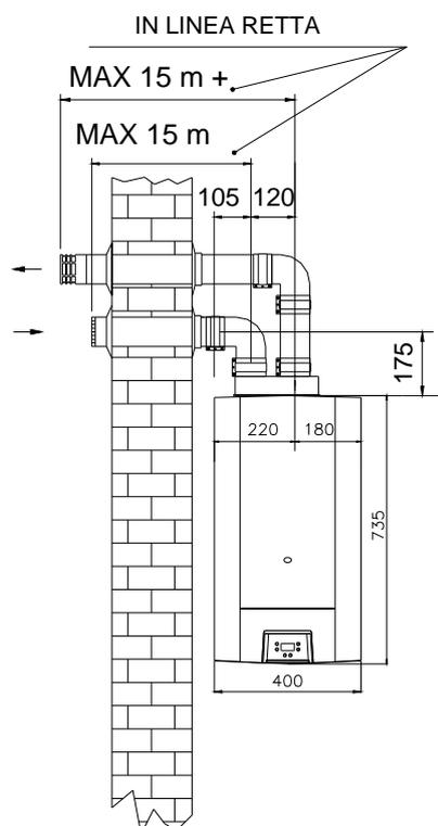
N.B.: La somma della lunghezza del tubo di scarico e quella del tubo di aspirazione non deve superare i 30 metri.
