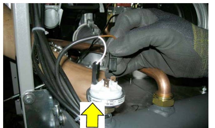
- Rimuovere la connessione pressostato gas.
