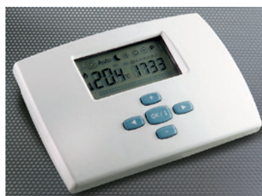
Umidostato (agisce direttamente sul Deumidificatore in funzione dell'umidità rilevata in ambiente e quella impostata sul dispositivo) cod. 3.023302
