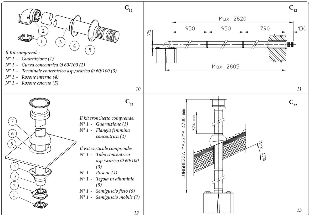
**1.12 INSTALLAZIONE KIT SEPARATORE. Configurazione tipo C a camera stagna e tiraggio forzato.**
