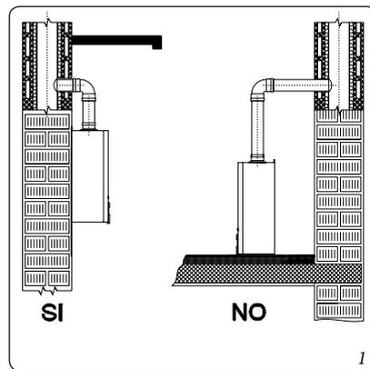
**Attenzione:** l'installazione dello scaldabagno sulla parete, deve garantire un sostegno stabile ed efficace al generatore stesso.
