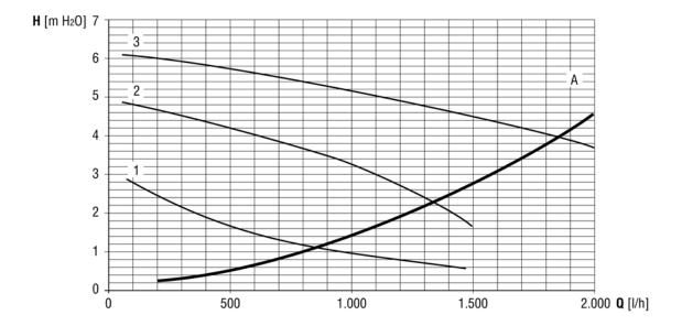
Perdita di carico caldaia 1-2-3 Velocità circolatore
