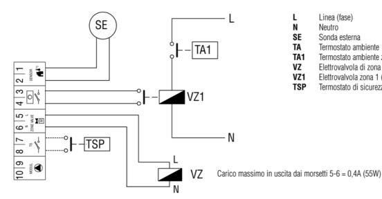
L Linea (fase) N Neutro SE Sonda esterna TA Termostato ambiente
