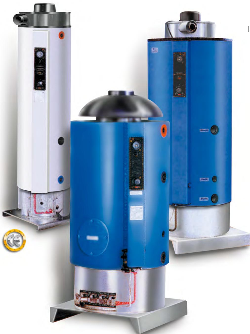
Gli scaldabagno ad accumulo funzionanti a gas naturale o a G.P.L. che compongono la linea "SAL", si presentano in tre modelli a camera aperta con tiraggio naturale e cinque modelli a camera stagna con tiraggio forzato.
