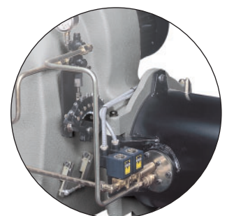
Gruppo valvole e camma a profilo variabile
