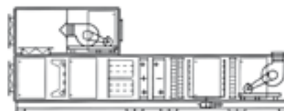
Unità trattamento aria parzialmente sovrapposta.
