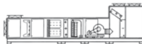
Unità trattamento aria tipo multizona.
