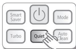
Premere il pulsante **Quiet** del telecomando mentre l'apparecchio sta funzionando in modalità di raffreddamento o di riscaldamento.
