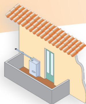
Installazione ad altezza parapetto*
