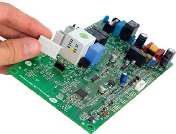
All'interno di questa Sim vengono memorizzate tutte le caratteristiche di funzionamento della caldaia.
