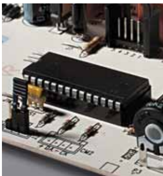
Microprocessore per gestione elettronica integrata
