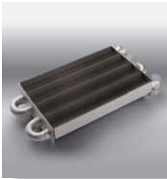
Scambiatore monotermico in rame con rivestimento silconico, a tubi cilindrici, ad alto rendimento
