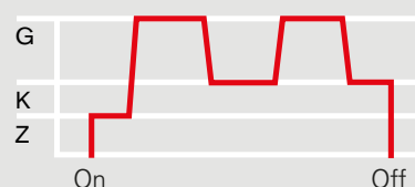
due stadi con servomotore
